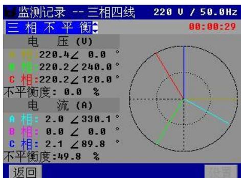
图 4-36 监测记录电压/电流不平衡
