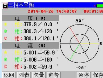
图 4-27 不平衡测量矢量图
