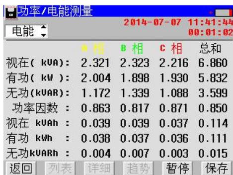
图 4-23 (b) 电能测量界面
