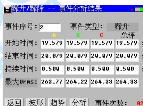
图 4-47 电压骤升/骤降事件分析
