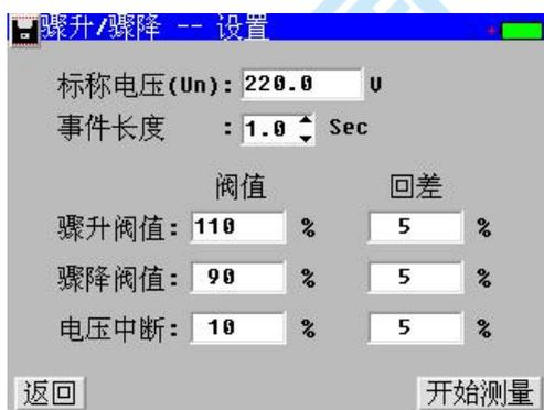
图 4-43 电压骤升/骤降中断设置
