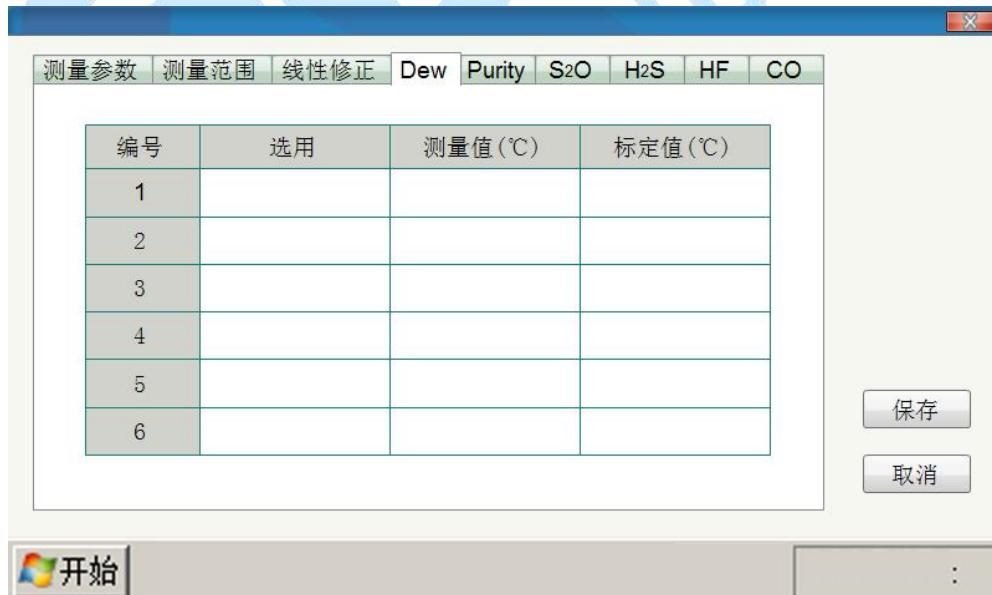
多点标定界面中，用户可以定义露点、S2O、H2S、CO、H2、HF 的多点标定参数。用户最多可以定义 5 点标定。点击**保存**按钮则保存用户定义的输入。点击**取消**则忽略用户输入。点击**关闭**则回到主界面。
