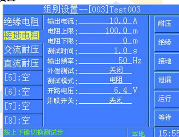
图 3-2-7-1 接地电阻设置界面
