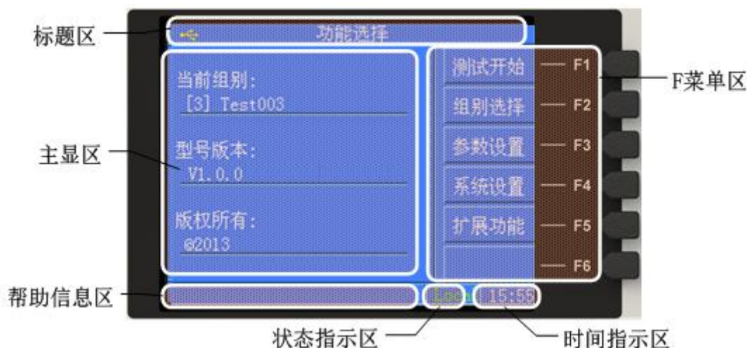
图 3-2-1-2 液晶面板示意图
