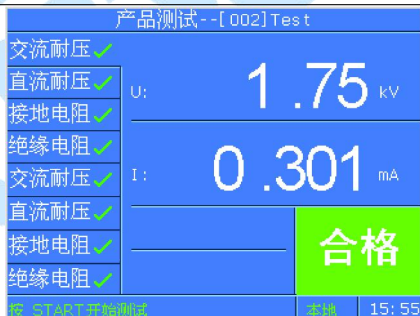
图 3-2-5-9-1 测试完成后单步测试结果显示界面
